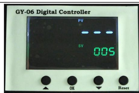
Presione después de ajustar la temperatura y la luz de tiempo está encendida. Seleccione con flechas el tiempo según el material de transferencia diferente.
