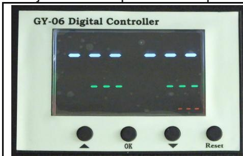
Encienda el interruptor de encendido, la luz de temperatura está ENCENDIDA. La pantalla digital muestra lo anterior.
