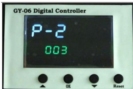
Cuando hay diferencia de temperatura entre SV (la temperatura actual de calefacción se muestra en el pantalla de visualización) y la temperatura real de la placa de calor, por favor mantenga pulsado el botón durante 5 segundos para entrar en el modo P-1 para calibrar.
