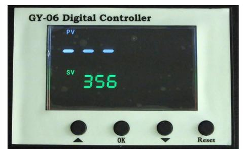
Pulse boton, de temperatura se encendera. Seleccione con las flechas la temperatura según el material de transferencia (normalmente 180 °C ~ 200 °C)
